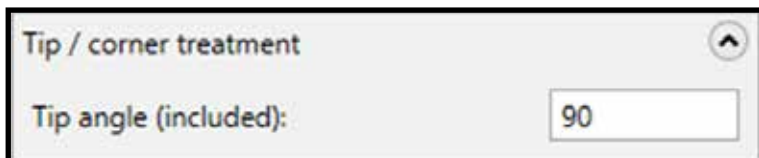
Gambar 2.10. Pengaturan tip/ corner treatment pada countersink
