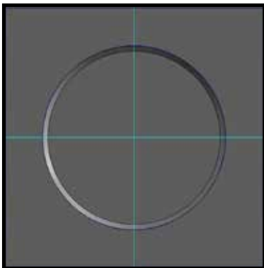
Hasil pembentukan kolom/ kantong/ pocket dengan dinding miring 5°
