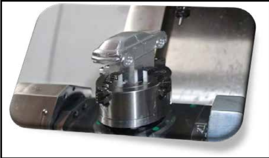
Gambar 1.7 Proses di mesin CNC setelah CAM
