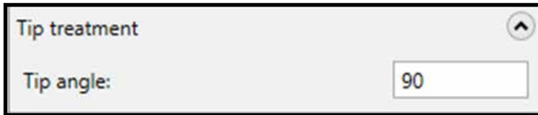
Gambar 2.26, pengaturan tip treatment pada spot Drill
