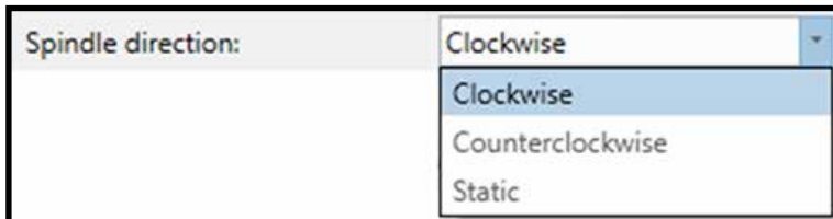
Gambar 2.32. Pengaturan arah putaran spindel pada mastercam 2019
