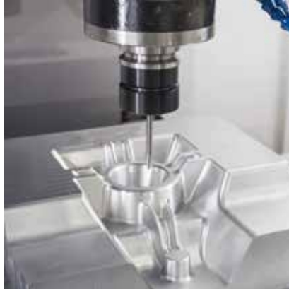
Gambar 2.21 Proses pengeboran dengan CNC milling Sumber : https://geomiq.com/cnc-machining-technology/
