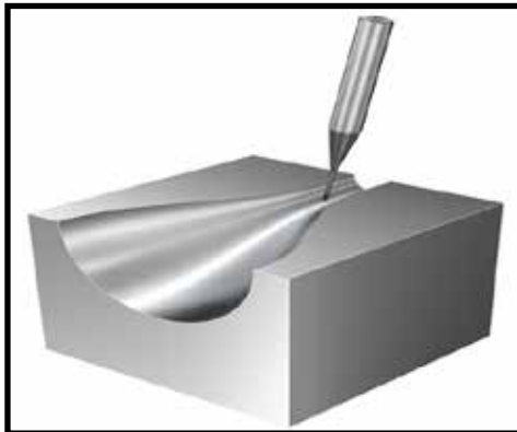
Gambar 2.2 Machining dengan Ballnose endmill
